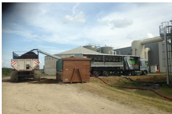
Camion avec séparateurs de phase intégrés – débit 250 m3/heure
