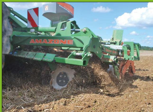
Le semis sur un déchaumeur est envisageable pour des espèces peu exigeantes (moutarde, radis, phacélie), la graine doit être positionnée dans le flux de terre avant le passage du ou des rouleaux.
