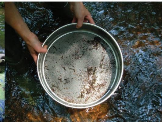
Prélèvement de macro-invertébrés - Tamis maille 500 µm
