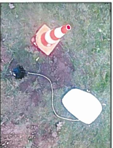
Photo 5 : Essai d'infiltration Porchet (Labocea)
