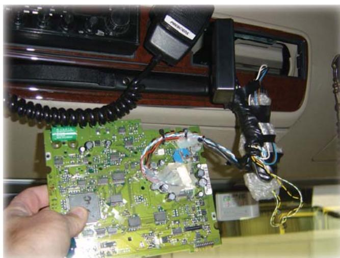
Dispositif de fraude au chronotachygraphe (système électronique illégal de double capteur de mouvement)
