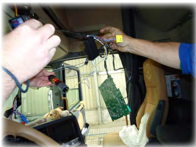
Démontage d'un dispositif frauduleux au chronotachygraphe
