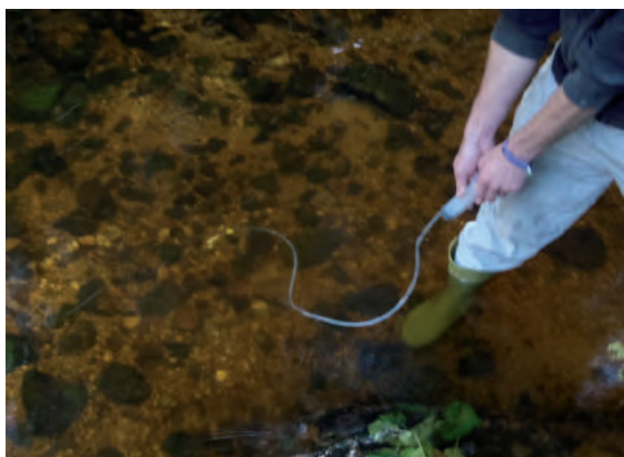
Seringue équipée pour prélever de l'eau interstitielle.
