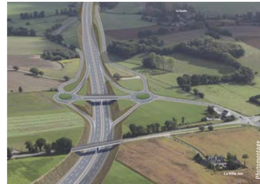
Échangeur ouest dans le cas de la variante « aménagement sur place », aménagement quasiment identique pour les deux autres variantes.
