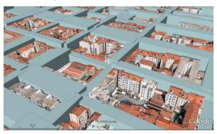
Figure 63: Illustration des volumes de rue-canyons dans SIRANE (source : ECL – LMFA)
