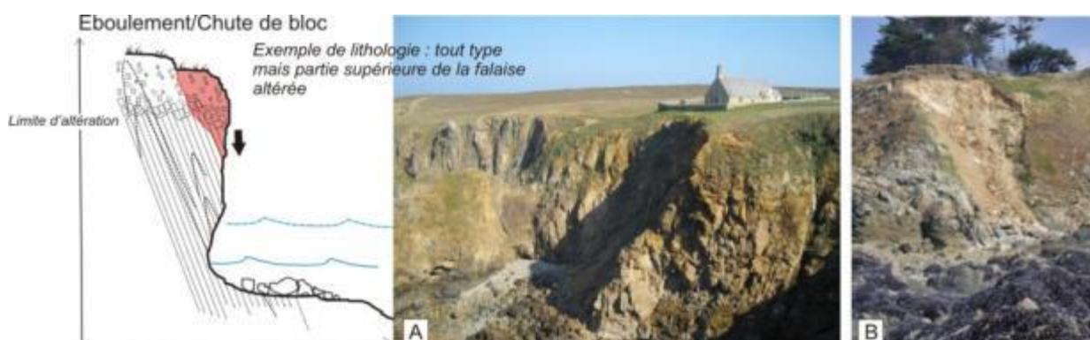
Illustration 61 : Schéma de principe d'un éboulement/Chute de blocs (A : Pointe du Van, 29 ; B : Planguenoual, 22).
