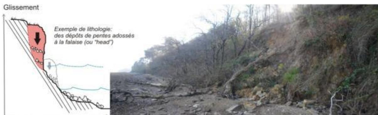
Illustration 58 : Schéma de principe d'un glissement de terrain (Landevennec, 29).
