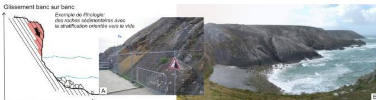
Illustration 59 : Schéma de principe d'un glissement banc sur banc (A : Binic, 22 ; B : Cap à la Chèvre, 29).
