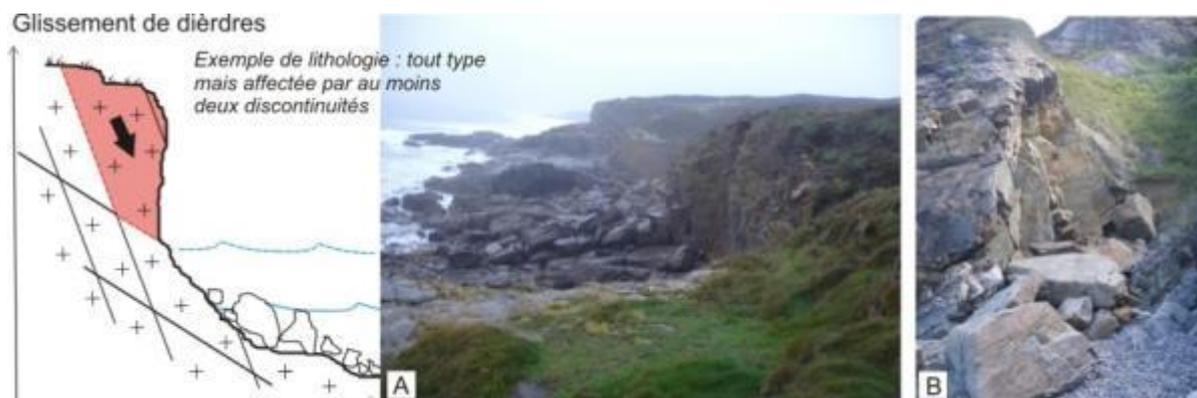
Illustration 60 : Schéma de principe d'un glissement de dièdres (A : Kerfany, 29 ; B : Plouha, 22)
