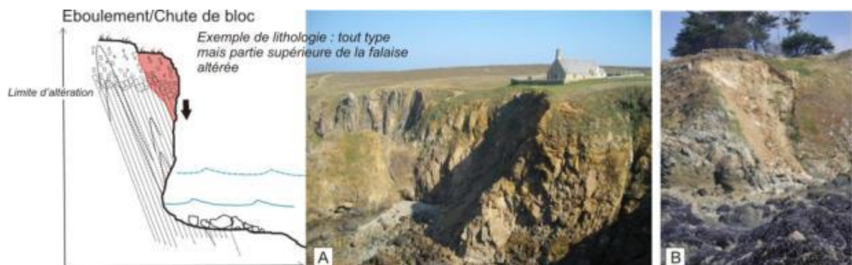
Illustration 55 : Schéma de principe d'un éboulement/Chute de blocs (A : Pointe du Van, 29 ; B : Planguenoual, 22).
