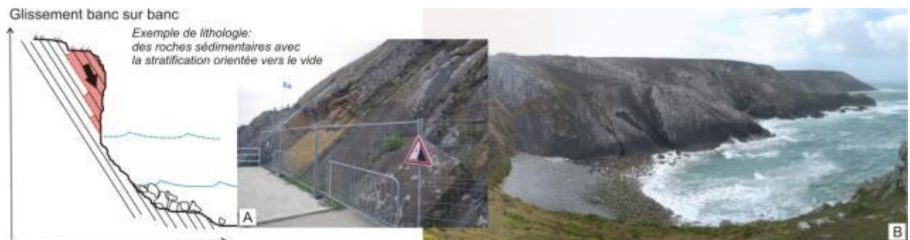
Illustration 53 : Schéma de principe d'un glissement banc sur banc (A : Binic, 22 ; B : Cap à la Chèvre, 29).
