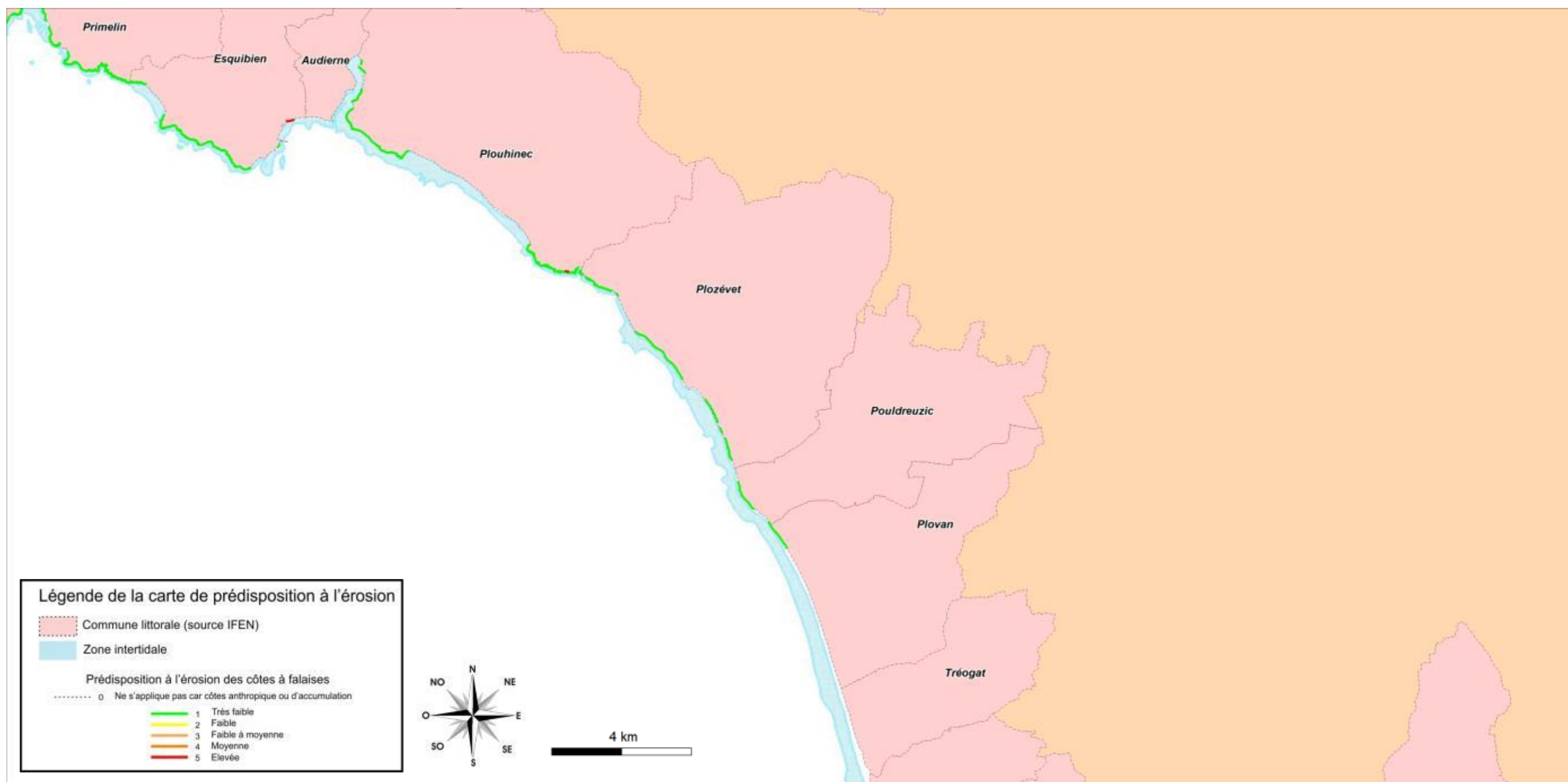
Illustration 69 : Note finale de prédisposition à l'érosion des côtes à falaises du compartiment C8.
