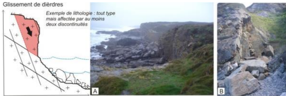
Illustration 54 : Schéma de principe d'un glissement de dièdres (A : Kerfany, 29 ; B : Plouha, 22).
