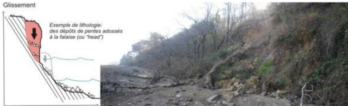
Illustration 52 : Schéma de principe d'un glissement de terrain (Landevennec, 29).
