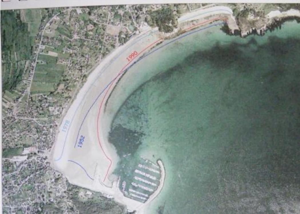
Illustration 45 : Photographie aérienne IGN de 2000 avec superposition des limites entre plage et mer observées sur les photographies aériennes IGN de 1952, 1978 et 1990 (Latteux B., 2003).
