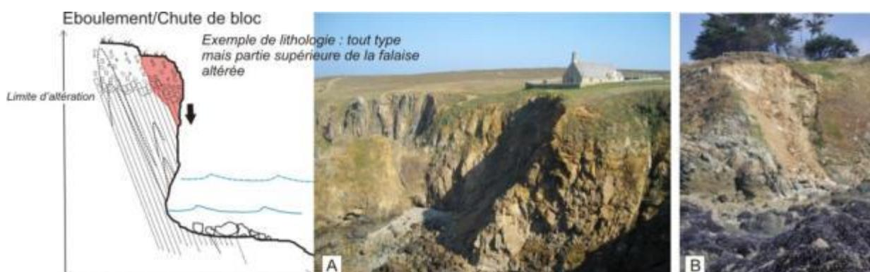
Illustration 81 : Schéma de principe d'un éboulement/Chute de blocs (A : Pointe du Van, 29 ; B : Planguenoual, 22).
