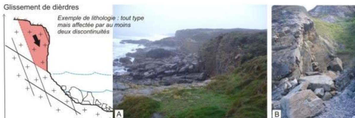
Illustration 80 : Schéma de principe d'un glissement de dièdres (A : Kerfany, 29 ; B : Plouha, 22).
