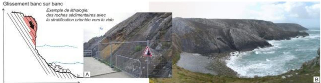
Illustration 49 : Schéma de principe d'un glissement banc sur banc (A : Binic, 22 ; B : Cap à la Chèvre, 29).
