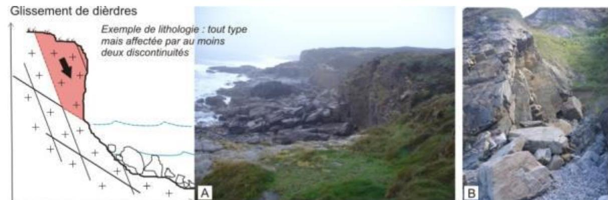
Illustration 50 : Schéma de principe d'un glissement de dièdres (A : Kerfany, 29 ; B : Plouha, 22).
