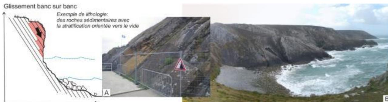
Illustration 43 : Schéma de principe d'un glissement banc sur banc (A : Binic, 22 ; B : Cap à la Chèvre, 29)
