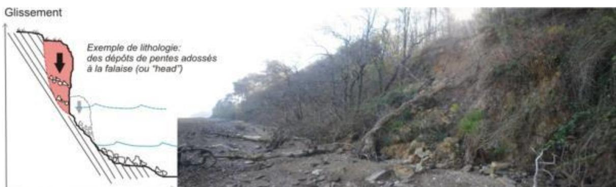
Illustration 42 : Schéma de principe d'un glissement de terrain (Landevennec, 29).
