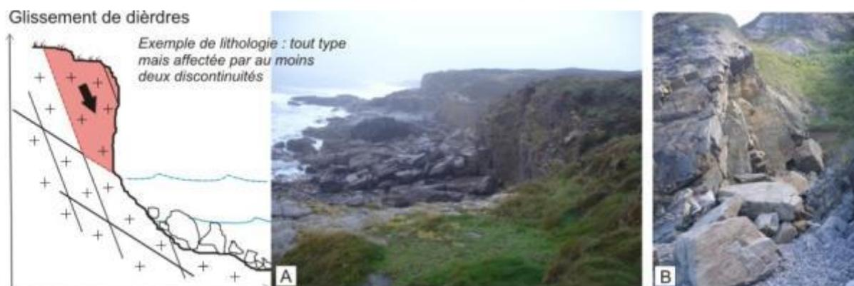
Illustration 44 : Schéma de principe d'un glissement de dièdres (A : Kerfany, 29 ; B : Plouha, 22).
