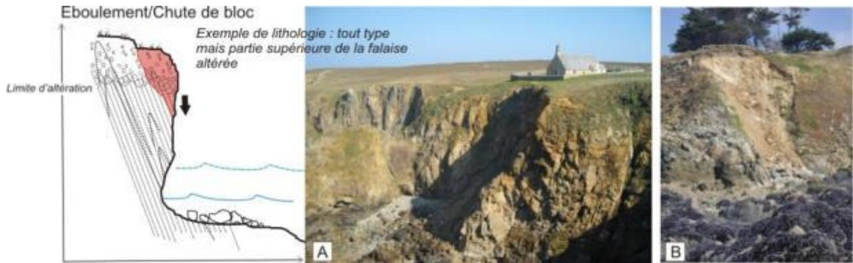
Illustration 51 : Schéma de principe d'un éboulement/Chute de blocs
