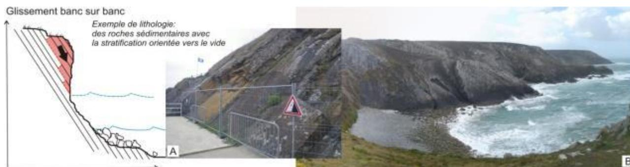
Illustration 49 : Schéma de principe d'un glissement banc sur banc (A : Binic, 22 ; B : Cap à la Chèvre, 29).
