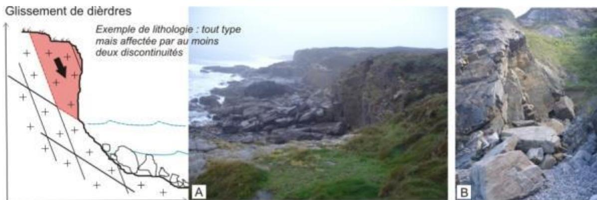
Illustration 64 : Schéma de principe d'un glissement de dièdres (A : Kerfany, 29 ; B : Plouha, 22).
