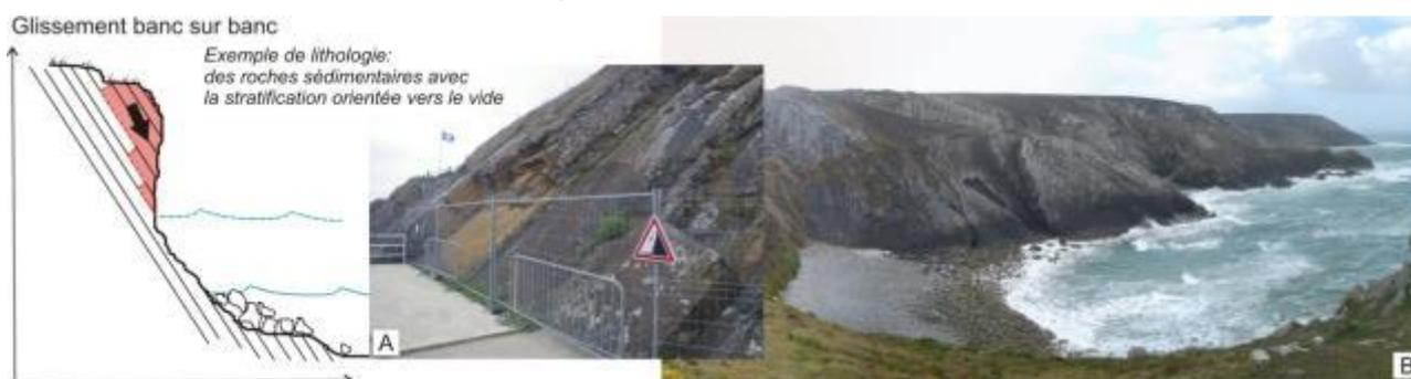
Illustration 63 : Schéma de principe d'un glissement banc sur banc (A : Binic, 22 ; B : Cap à la Chèvre, 29).
