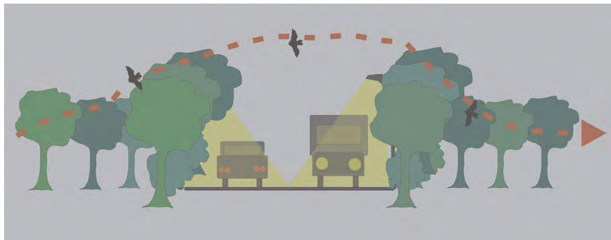
Figure 59 : Principe d'un Hop-over (source H. Limpens)
