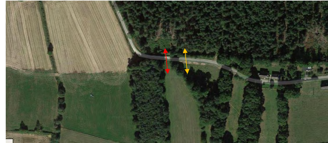
Figure 50 : Proposition de décalage du passage inférieur vers l'ouest (flèche rouge : nouveau positionnement, flèche orange : ancien positionnement) (Source : Egis)
