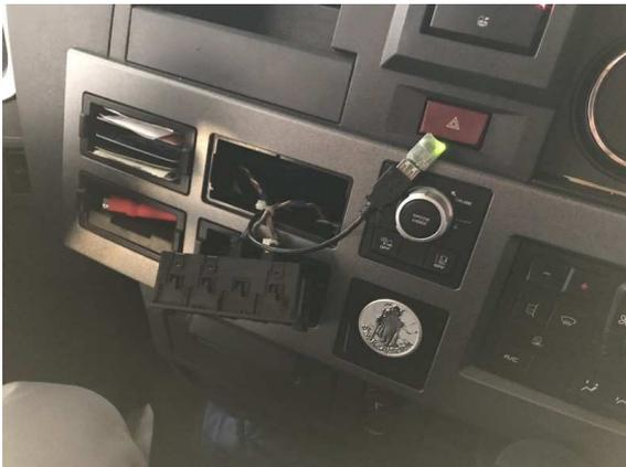
Ce dispositif pirate atteint un niveau d'élaboration jusqu'alors jamais rencontré. Il consiste en la modification interne du software de l'appareil de contrôle numérique. L'insertion d'une mini clé USB dans un port caché derrière le tableau de bord neutralise tout enregistrement de conduite tout en conservant active l'information vitesse. Cette manipulation permet de masquer les temps réels de conduite.
