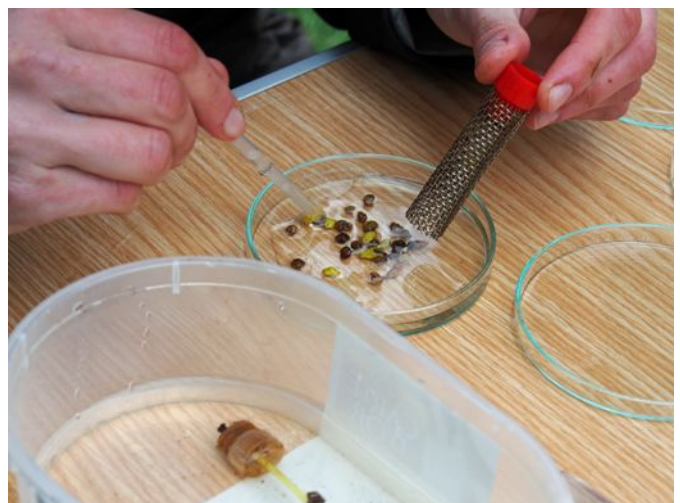
Les tubes grillagés (ou bigoudis) sont utilisés comme système d'élevage in-situ dans les rivières. La survie et la croissance des moules y sont régulièrement mesurées (René-Pierre Bolan).
