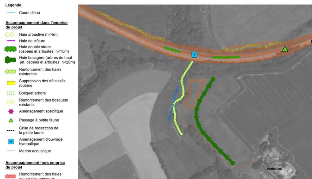
L'ouvrage hydraulique prévu à cet endroit entraînera une amélioration légère de la situation par rapport à l'existant (buse de diamètre 3m) : augmentation légère de la largeur, forme rectangulaire de l'ouvrage, etc.
