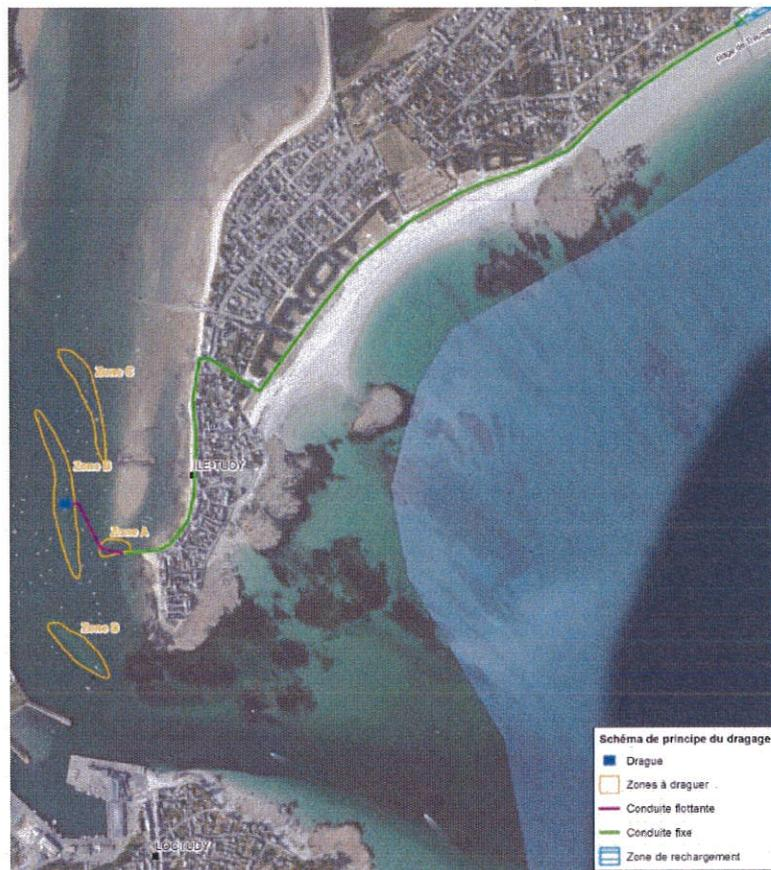
Dragage et acheminement des sédiments par une conduite de refoulement jusqu'à la plage du Treustel (extrait étude d'impact)
