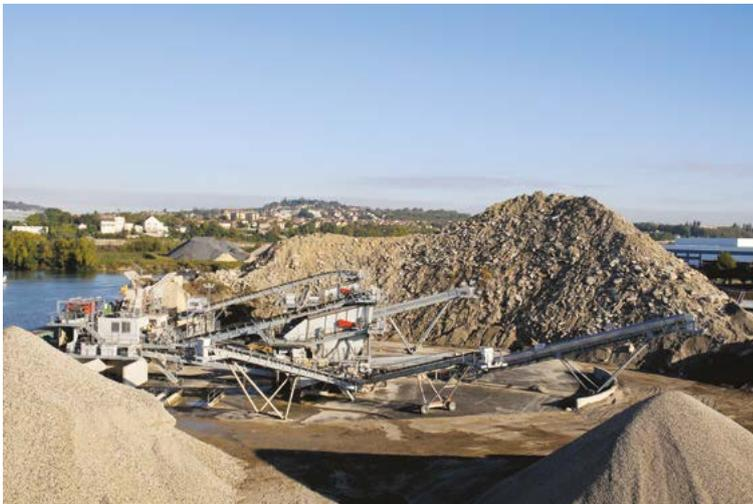
*Illustration 2 : Installation fixe de concassage criblage (Source : VINCI).*
