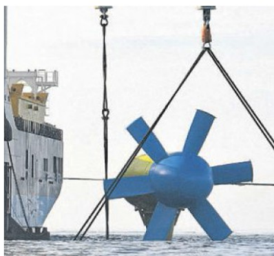
L'imposante hydrolienne de Sabella lors de son immersion.
