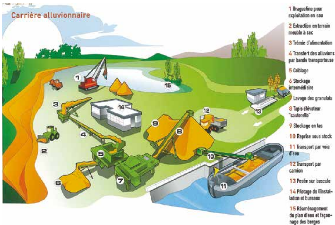
Schéma d'exploitation d'une sablière - source : UNICEM
