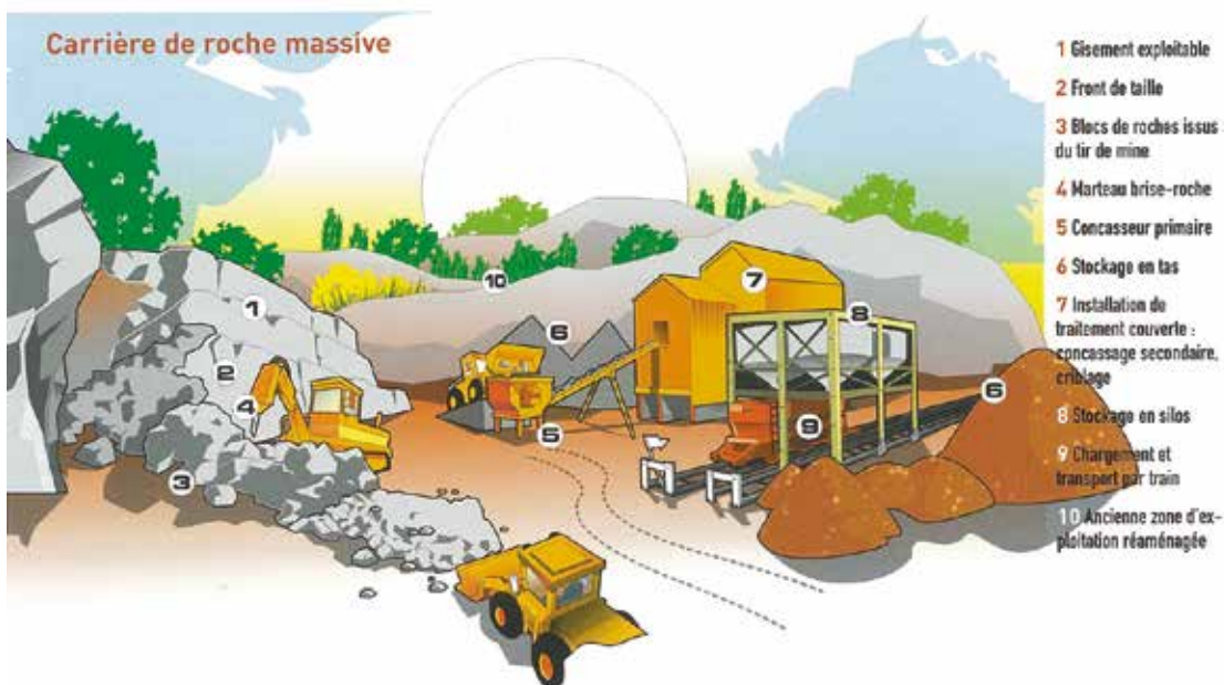
Schéma d'exploitation d'une carrière de roche massive - source : UNICEM
